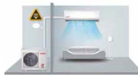
Indikátor úniku chladivého plynu sa aktivuje
